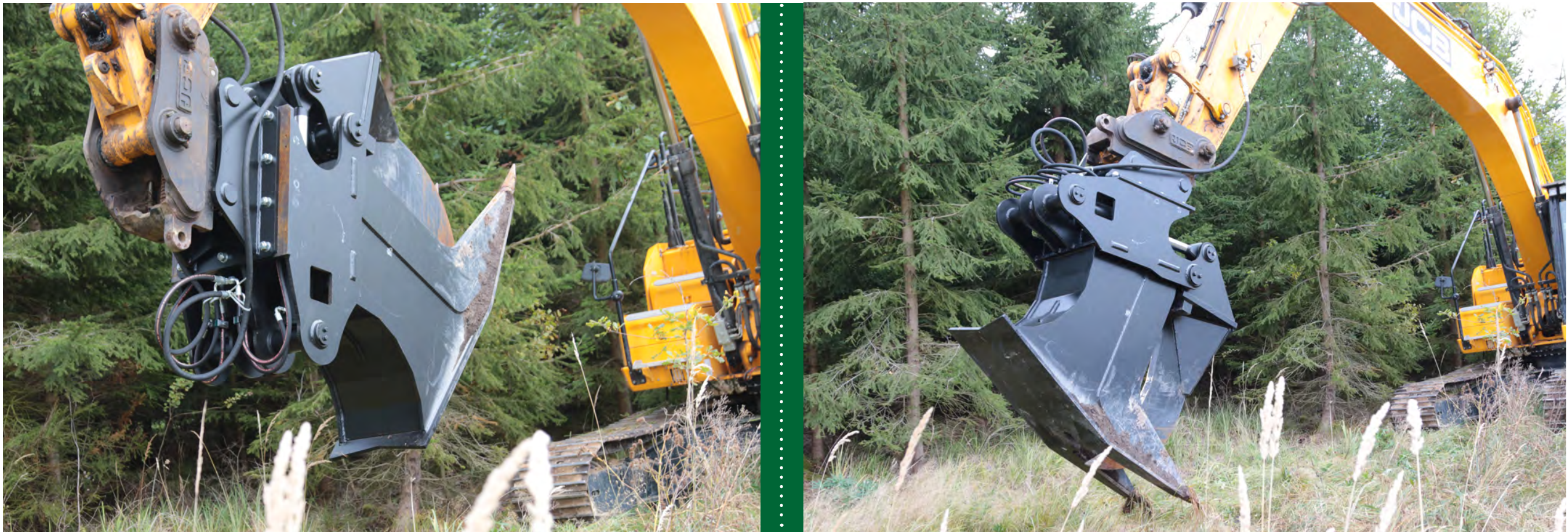
Napojení hydraulického systému na klučicí hlavici od výrobce STS Prachatice
